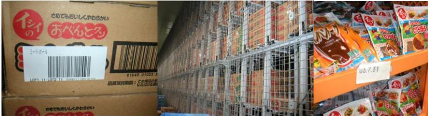
金属探知機、X線検知機で異物をチェックした後箱詰めする。出荷先によっては、テープで2個組に束ね搬出用ケースに詰める。箱には以降の物流管理で使うITFコードを張り（配送先情報を含む1次元バーコード）、配送先ごとに自動倉庫に入庫・一時保管する。
