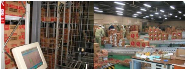
自動倉庫から出庫した後は、方面別に自動仕分けされる。作業員によるロールボックス・平パレットへの積載を経て、トラックで出荷する
